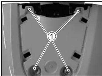
3. 拆下前下护板2个上固定螺钉②。
