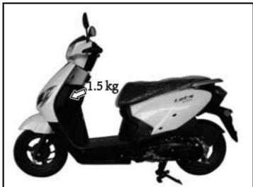
头盔挂钩的载重不能超过 1.5 kg，后货箱的载重不能超过 5kg。部分车型无后货架或后尾箱，禁止载重。
