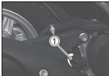
2. 拆下机油注油塞①，在放油螺栓的下方放一接油盆。
