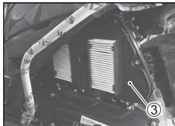
3. 拆下的空气滤清器如右图所示。
