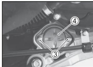
5. 拆下机油滤芯盖，使用尖嘴钳取出旧的机油滤芯。拆下橡胶圈。
