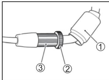
2. 通过顺时针或逆时针旋转调节器 ③ 调节油门转把游隙。标准游隙间隙 2.0-4.0mm。
