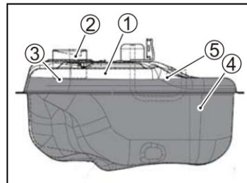
本车设有燃油挥发回收装置——碳罐。可吸收燃油箱内的燃油蒸汽到碳罐中。当发动机启动后，碳罐中
