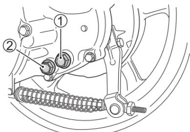
3. 拆掉油位塞①并检查油位。若油位低于油位孔，则应加油直至油从油位孔流出。
