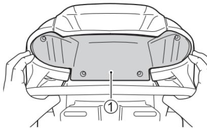
1. 拆下螺钉并取下透镜①。取下和更换透镜时盖上护罩，以免划伤透镜。
