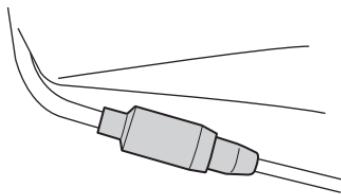
油门拉筋线配备保护罩。检查保护罩是否牢固安装。清洗时请勿直接将水撒到保护罩上。保护罩变脏时，用湿布将其上的灰尘擦掉。
