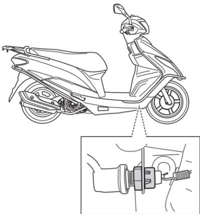
为调整制动灯开关，握住开关主体并转动调节器，使得在踩下制动踏板感到压力增加时制动灯亮。
