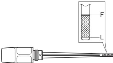
采用机油量油尺检查机油油位。油尺应连同如图所示的加油孔一起使用。油尺上的油位应在“L”（低）和“F”（满）两条线之间。
