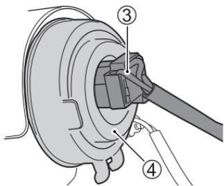
6. 拔开插座 ③，并拆下橡胶帽 ④。
