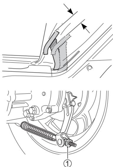
顺时针或逆时针转动调节器 ① 以调整 20-30 毫米的游隙。顺时针转动该调节器 ① 将缩小游隙。
