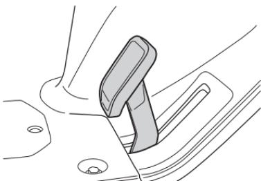
踩住后制动踏板使后制动发生作用。制动指示灯将在制动时点亮。
