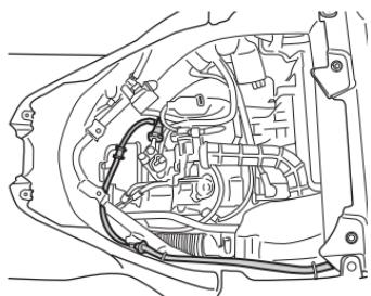
3. 检查燃油软管是否损坏并存在燃油泄漏。一旦发现任何缺陷，则应更换燃油软管。
