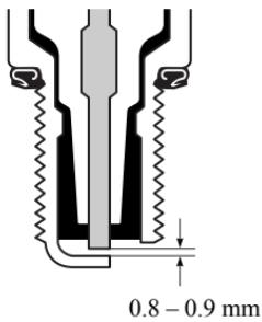
定期清理火花塞上的积炭。使用火花塞间隙规再次将火花塞间隙调整到0.8至0.9毫米。
