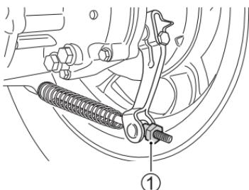
操作后制动时，测量制动手柄末端和车把套之间制动手柄的活动距离。该距离应为 15-25 毫米。每次骑车前确认该游隙，如有必要，可依据下列步骤调整该游隙：
