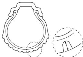
每天骑行前检查轮胎的状态。如果轮胎有明显损坏，例如：裂纹或切口，或者如果轮胎的前胎纹深度或后胎纹深度不大于 0.8 毫米，则应进行更换。
