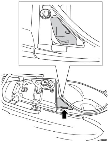
随车工具位于鞍座下方。取下工具箱盖。
