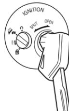
1. 将点火钥匙头和点火开关上的方孔相匹配。
