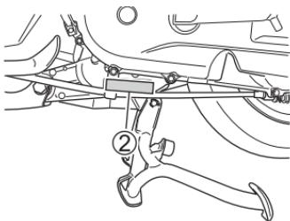
车架号码和发动机序号码用于登记摩托车。当订购零部件或特殊服务时，此编号将能帮助经销商为您提供更好的服务。车架序号码①打印在车架后部。发动机号码②印在曲轴箱组件上。
