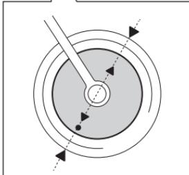
油箱盖位于座位下方。如需打开油箱盖，则将其逆时针方向旋转。如需关闭油箱盖，则将其顺时针方向旋转直到盖子上的三角形标志与托盘三角形标志对准。
