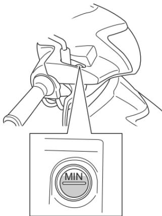
检查储液盒中制动液的液位。如果储液盒中制动液液位低于下限，请检查垫片是否磨损和泄露。
