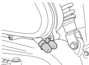
在定期维修间隔期拆除插塞、排水塞和排油塞。空气滤清器排水塞位于空气滤清器盒子下方。
