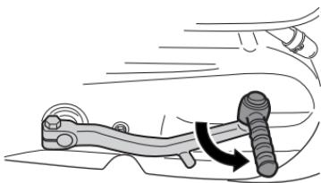
此摩托车配备了反冲起动杆，位于发动机的左侧。启动发动机，并用中心支架停稳摩托车，用力踩踏反冲起动杆。
