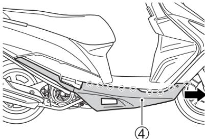
5. 松开左右侧暗扣。拆下车架下罩 ④ 并将其向前滑动。
