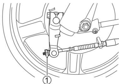
经在制动手柄末端测量，制动手柄轻拉至油门转把时，前制动手柄间隙应为 15-25 毫米。每次骑行前检查该间隙，如有必要可进行如下调整：
