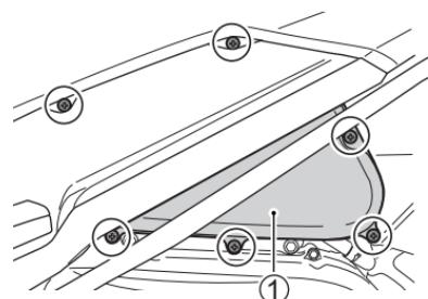
1. 拆除螺丝钉和空气滤清器盖①。
