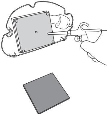
3. 使用空气软管小心将空气滤清器滤芯中的灰尘吹掉。
