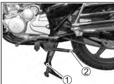
要打开侧支撑时，应将脚放在侧支撑的延伸部分。顺时针转动，直到支架转到尽头。
