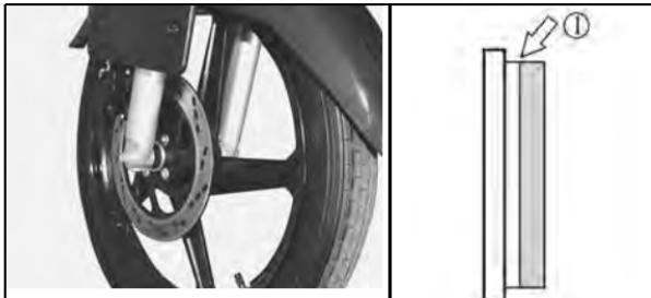
检查前刹车片的要领是检查该片是否磨损到限度线①，如果磨损超过此限度线，应更换新品。
