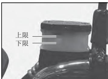
“LOWER”（下限）之间。如果制动液液位低于“LOWER”（下限），应及时添加济南铃木推荐的美孚牌 DOT3 型制动液。制动卡钳中的刹车片磨损时，制动储液盒内的存液注入到制动油管中，导致液面下降。补充制动液是定期检修中的重要项目。
