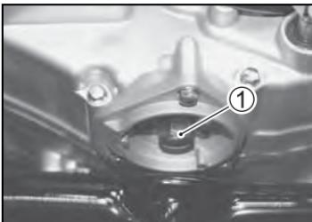
4. 拆下机油滤芯盖的 3 个螺栓 ②；取下机油滤芯盖 ③。
