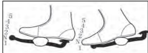
本型号摩托车装有五档速度齿轮啮合变速箱，它的操作机构如图所示，变档杆连着变速箱中的棘轮机构。选用一个档位后，变档杆会自动返回到原位置，以便换下一档位。空档位于一档和二档之间。从空档位置踩下变档杆便挂上一档。每把变档杆网上提一档就进一个档位。由于是采用了棘轮机构，不能一次加减两个档位以上。由于二档变一档，或由一档变二档时，中途滑过空档位置并不停在该处。如果需要挂入空档，在一档变二档过程的中间
