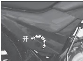
2. 使用梅花型螺丝刀拆卸 7 个空气滤清器外盖螺钉
