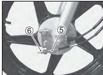
3. 微调整张力调整环③，调整到规定游隙后，锁紧锁定螺母②，并套上胶套④。
