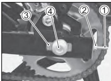
3. 松开左右锁紧螺母②，通过扭转调整螺栓①调整传动链条的松弛度。同时应注保持发动机链轮和后链轮在同一直线上。为帮助您完成这一步骤，后摇臂和各链条调节器上都有标记③，它们彼此对准，可用作两侧对应的参考。
