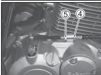
3. 微调整张力调整环③，调整到规定间隙后，锁紧锁定螺母②和⑤，并套上胶套④。
