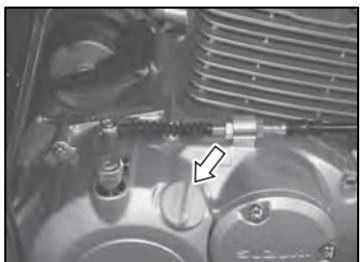
3. 拆下发动机底部的放油螺栓，将发动机内部的旧机油排出；
