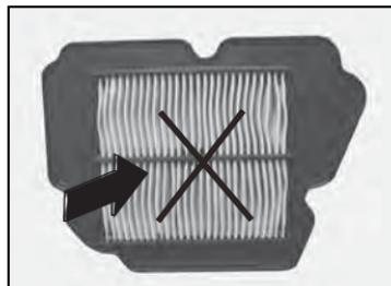
5. 按照与拆下时相反的顺序安装空滤器，确认滤清器元件装牢在规定位置并可靠密封。
