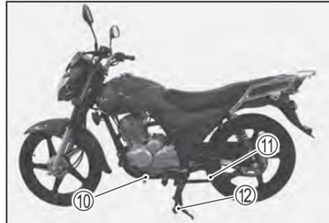
⑩ 变档杆 ⑪ 侧支撑 ⑫ 中心支架 ⑬ 反冲启动杆
