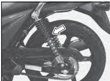
**调整方法：**支起中心支架，把弹簧张力环转到所需的位置。第一阶段最松软，第五阶段最坚硬。本车型出厂时暂定在第二阶段。
