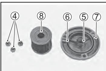
6. 把机油滤芯盖装复前，要详细检查机油滤芯盖的弹簧和密封垫圈⑨是否装正确。
