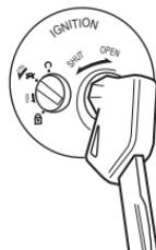
1. 将点火钥匙头和点火开关上的方孔相匹配。
