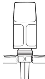
注：检查机油油位时，不得将加油孔拧入。
