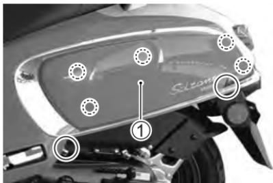
1. 拆除螺丝钉，松开卡扣，取下左护罩①。
