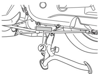
车架号码和发动机序号码用于登记摩托车。当订购零部件或特殊服务时，此编号将能帮助经销商为您提供更好的服务。车架序号码①打印在车架后部。发动机号码②印在曲轴箱组件上。
