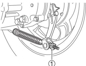
操作后制动时，测量制动手柄末端和车把套之间制动手柄的活动距离。该距离应为 15-25 毫米。每次骑行前检查该游隙，如有必要，可依据下列步骤调整该游隙：
