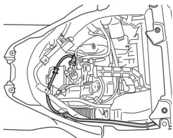
3. 检查燃油软管是否损坏并存在燃油泄漏。一旦发现任何缺陷，则应更换燃油软管。
