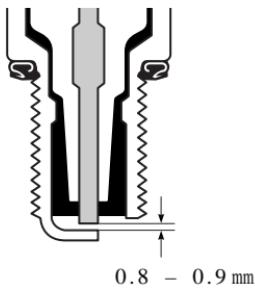
定期清理火花塞上的积炭。使用火花塞间隙规再次将火花塞间隙调整到0.8至0.9毫米。
