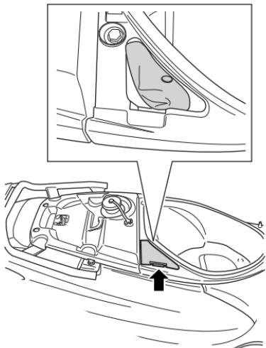
随车工具位于座椅下方。取下工具箱盖。
