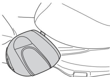
座位下有头盔挂钩。如需使用，只需打开座位，将您的头盔扣环挂到头盔挂钩上，再将座位调整到位即可。
