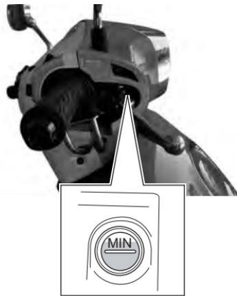
检查储液盒中制动液的液位。如果储液盒中制动液液位低于下限，请检查垫片是否磨损和泄露。
